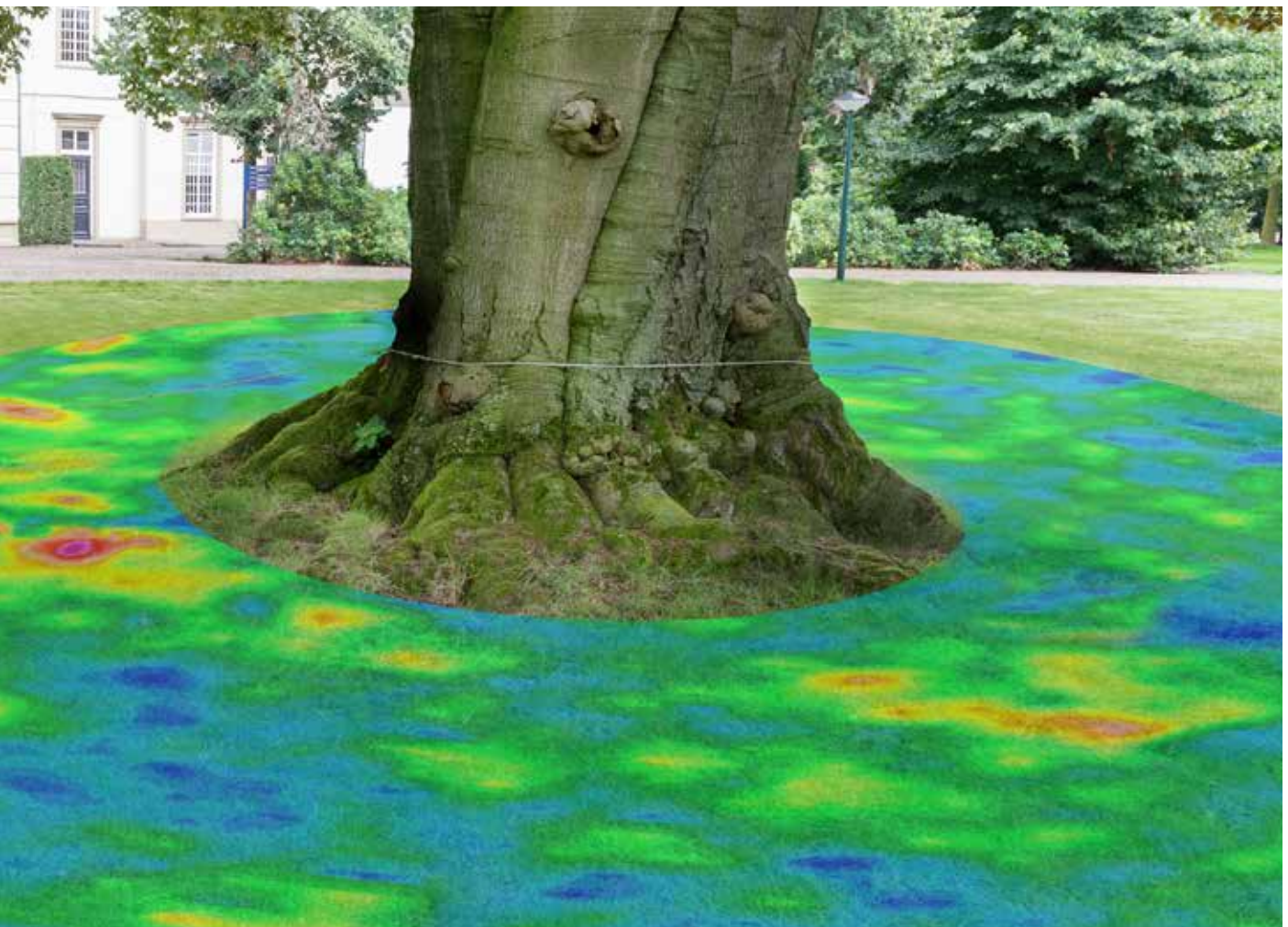
Grondradar geeft inzicht in het bewortelingsprofiel van een boom. In combinatie met grondboringen zijn nauwkeurig kwaliteit en omvang van het wortelstelsel te bepalen.
